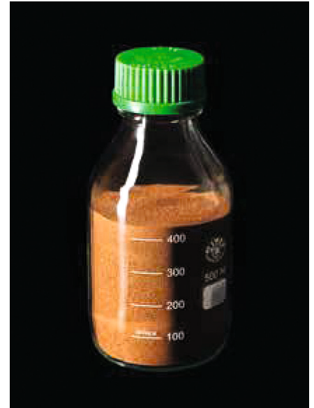
BC.ATOX Scon váže sirovodík do obtížně rozpustného sulfidu železnatého
