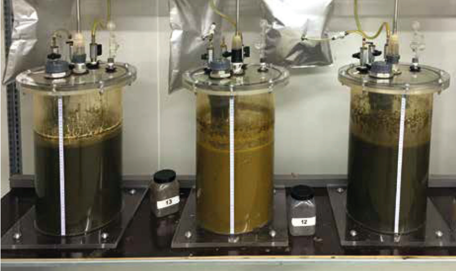
Panta Rhei – vše teče – příklad substrátu – 90 % slepičího trusu s obsahem 7,8g \text{NH}_4^+ a 90 g/l organické sušiny – v laboratorních fermentorech společnosti ISF Schaumann Forschung
