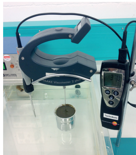
Rotační viskozimetr – jedno z měřících zařízení používaných v experimentu
