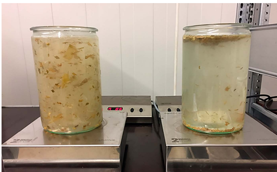
Obr. 4: Vlevo nádoba s BC. ZYM AL1, vpravo nádoba bez BC. ZYM AL1 s plovoucím substrátem
