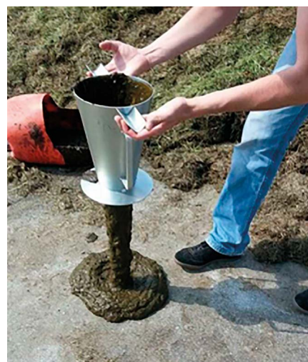
Obr. 2: Viskozita digestátu se určuje podle velikosti rozlité skvrny
