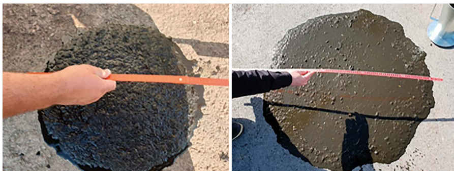
Obr. 3: Vysoká a nízká viskozita digestátu
